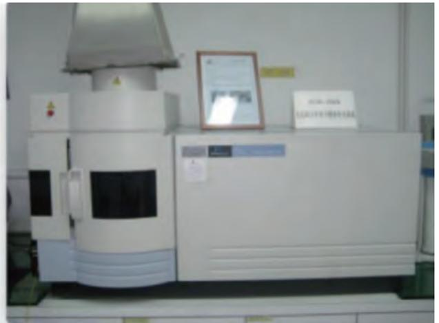
電感耦合離子體發光射光譜儀 ICP-OES
